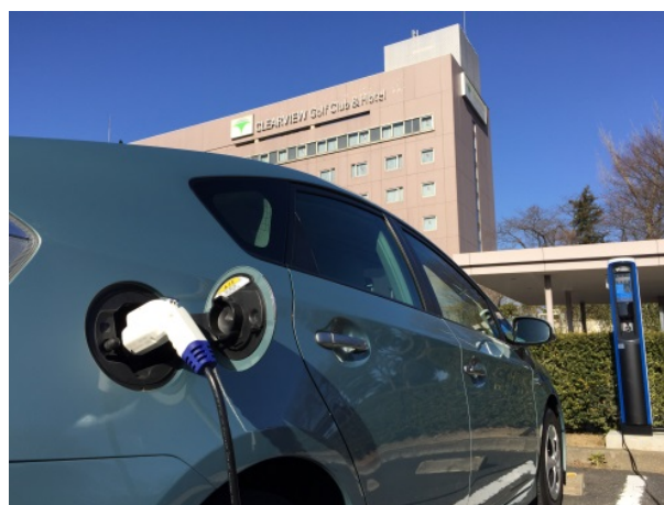
PHVで充電サービスを利用している様子
